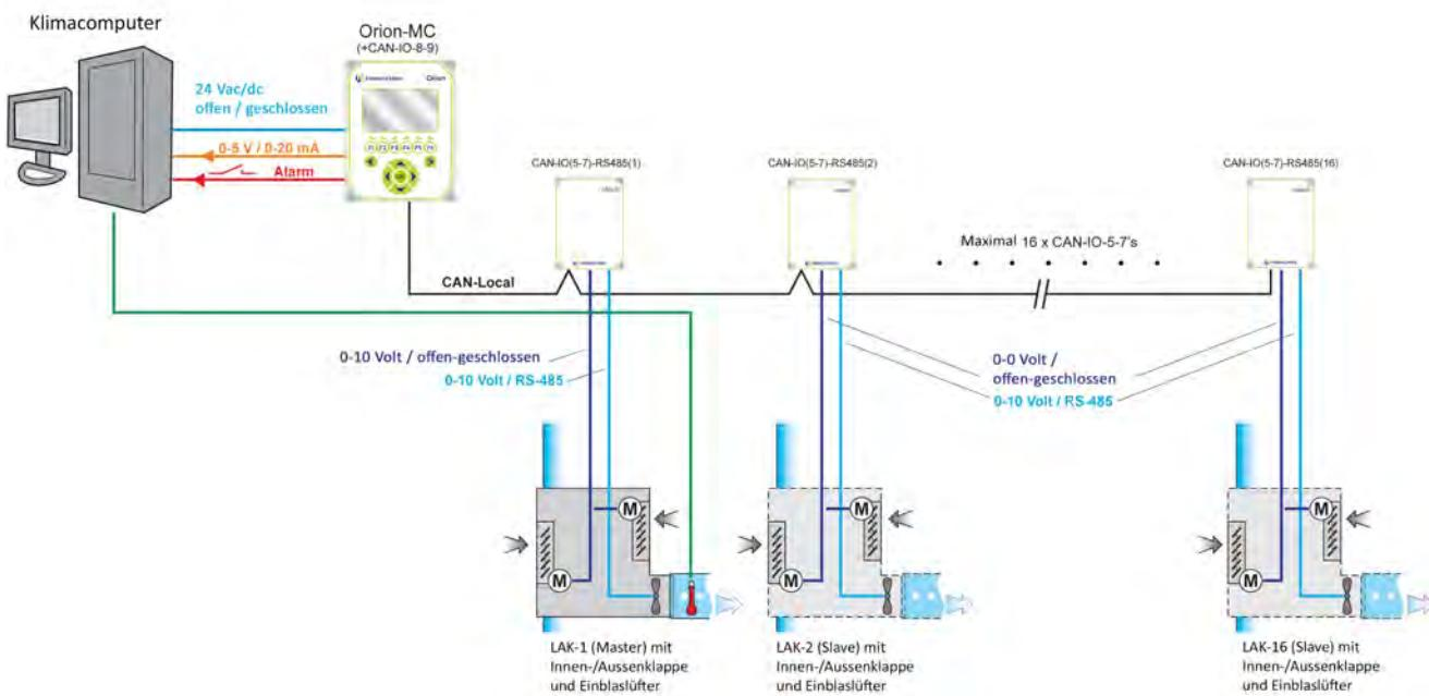
Lüftungsgeräte Innen-/Außenklappe mit Mischtemperatur- und Nachregulierung
