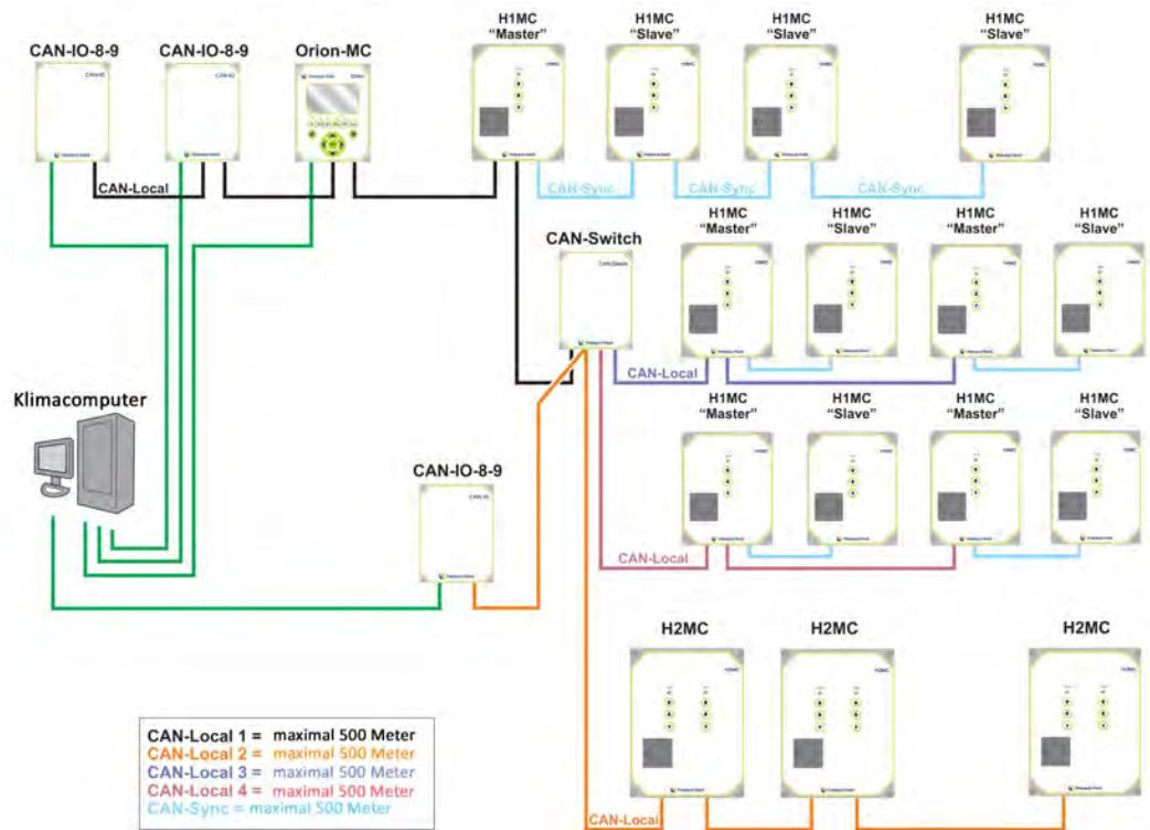
Fenster- und Schirm-Steuerung mit frequenzgesteuerten Motoren
