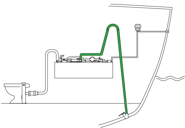
Auslass über Seeventil unter oder knapp über Wasserlinie
