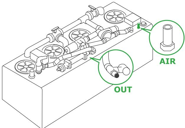
Luftfilter über der Anlage positionieren
