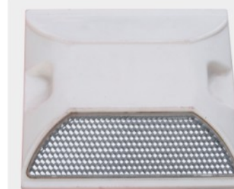
型号(model):LZL-DD-01 材料(material):塑料(plastic); PC反光片(PCreflective sheeting) 规格(specification):单面(single-side) 反光(reflective) 尺寸(size):100×100×20mm
