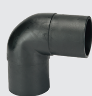
ELBOW 90° • d 20 - 225 mm * • Long • SDR11 \ SDR17
